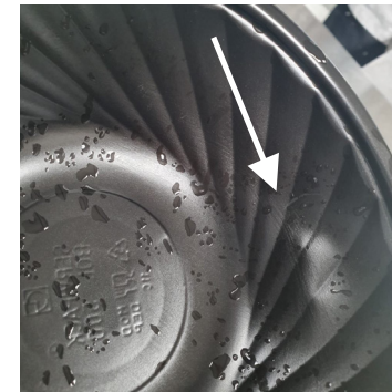
Photo d'un contenant CPET présentant de légères traces de lavage à la 8 ème rotation (en plus d'une déformation ayant eu lieu à la 7 e rotation)
