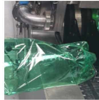
Photo d'une bouteille à usage unique broyée et éjectée de la machine de lavage
