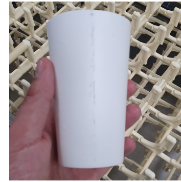
Photo d'un gobelet PP présentant une trace noire au bout du 3 e tour
