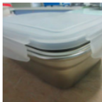
Déformation du couvercle sur le contenant
