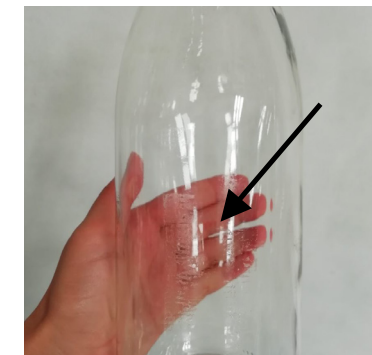
Photo de traces de colle résiduelles après lavage
