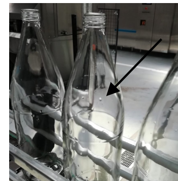
Photo de gouttes d'eau résiduelles après lavage
